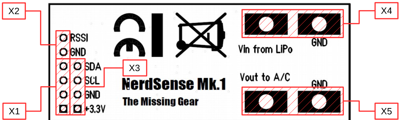
Abbildung 5: Übersicht aller Anschlüsse des Sensors
